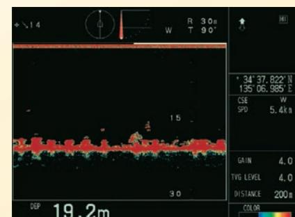
Khi rút được lên hoàn toàn, đầu dò ở góc nghiêng  $90^{\circ}$  có thể dò các đàn cá và đáy biển thẳng xuống dưới với tốc độ cao.
